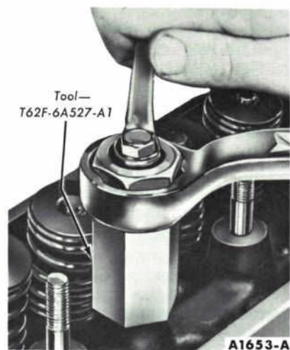
FIG. 14—Removing Rocker Arm Stud
